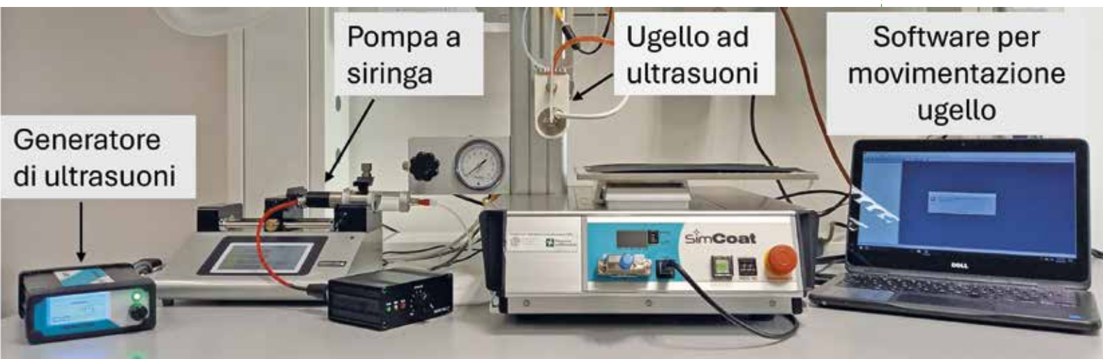
Figura 2. Immagine del setup sperimentale utilizzato per la preparazione dei rivestimenti nanocompositi mediante USS.
